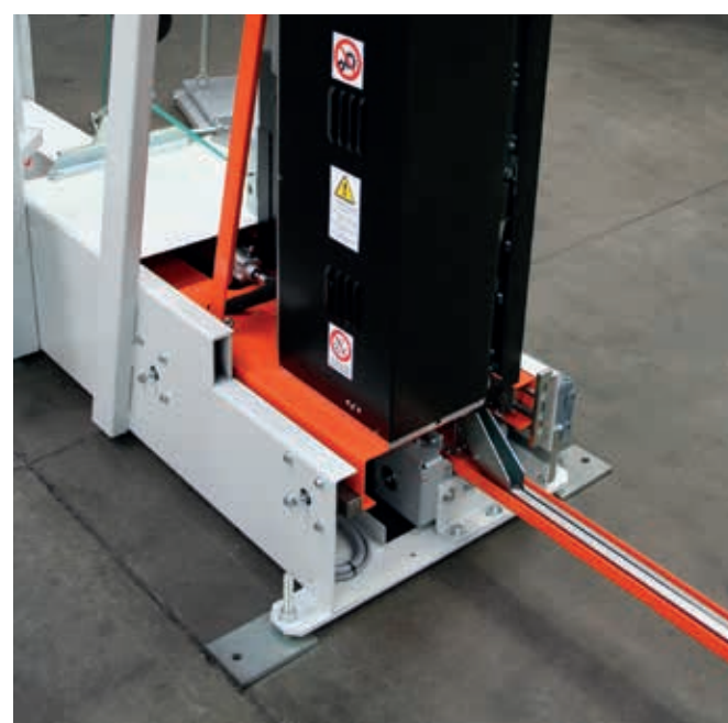
Baionetta per permettere la reggiatura attraverso il pallet
