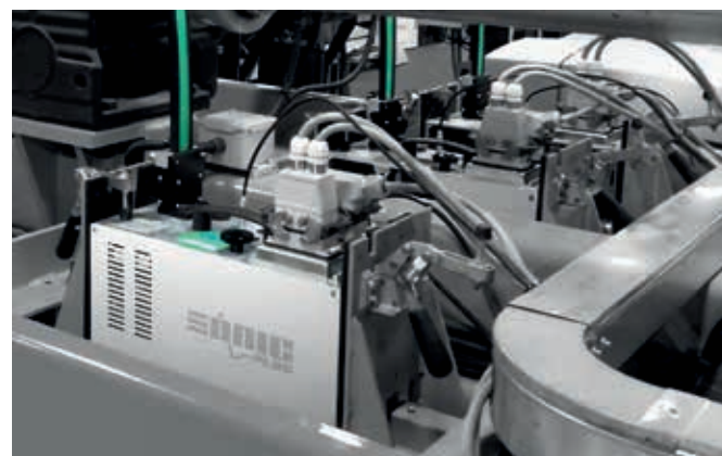
Installazione su reggiatrice verticale con pressa (applicazione settore cartonnaggio)
